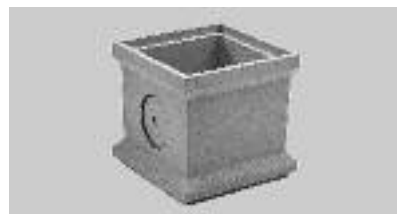
Nástavba z polymerického betonu pro vpust na prodloužení stavební výšky, předtvarování DN 100 na napojení střešního svodu – boční přítok.
