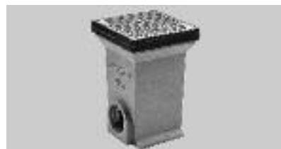
Dvorní vpust z polymerického betonu, litinový rám a rošt z pozinkované oceli – mřížkový, koš (PP), předtvarování s NBR-O-kroužkem pro nátrubek DN 100 a vyjímatelný uzávěr pachů.
