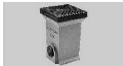
Dvorní vpust z polymerického betonu, litinový rám a rošt (GGG), koš (PP), předtvarování s NBR-O-kroužkem pro nátrubek DN 100 a vyjímatelný uzávěr pachů.
