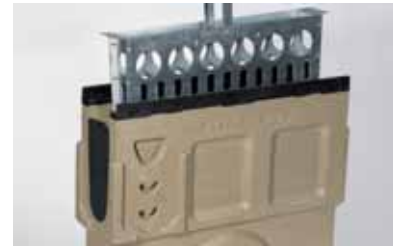
ACO DRAIN® PowerDrain® vtoková vpusť V 75 P s kalovým košem z pozinkované oceli, s vystřihovací připojovací šablonou, s integrovaným břitovým labyrintovým těsněním (alternativně s DN 110 nebo DN 160)
