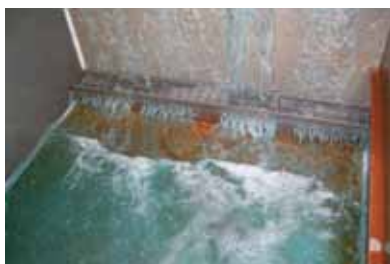
Zkouška žlabového tělesa s mřížkovým roštem 30 x 10 mm, volný tok, podpírané obložení
