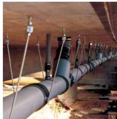
ACO Bridge pipe podélný svod s napojením mostních vpustí a trubiček odvodnění izolace
