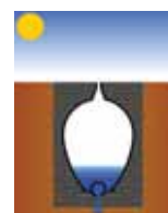
Konec srážek, regulovaný odtok pokračuje, hladina vody v žlabovém systému klesá.
