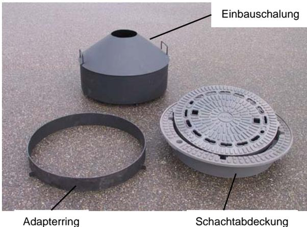
Der Deckel wird beim Schließen durch an der Deckelunterseite angebrachte Verriegelungsnocken verkehrssicher mit dem Rahmen verriegelt, und kann durch eine einfache Hebelbewegung mit einem entsprechenden Aushebwerkzeug entriegelt werden.
