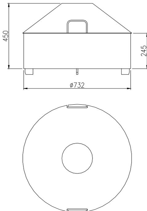
Einbauschalung aus Stahl für Schachtabdeckungen
