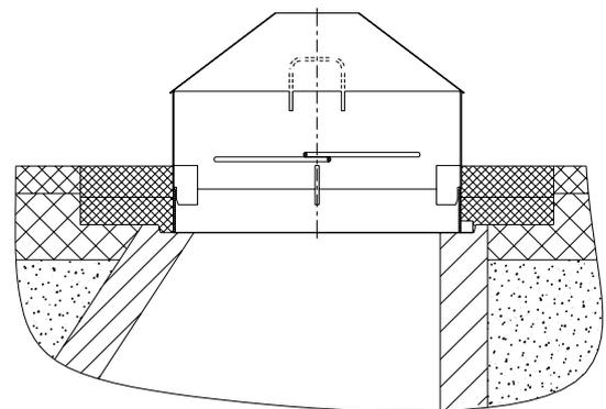
d) Einbauschalung vorsichtig und senkrecht nach oben ziehen und komplette Schachtabdeckung einsetzen.
