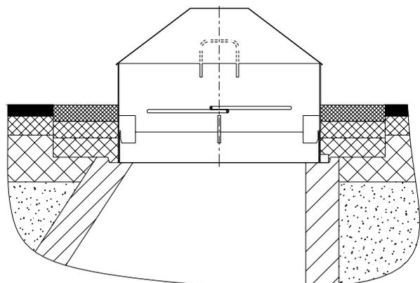
1.11 Einbauschalung vorsichtig nach oben ziehen und komplette Schachtabdeckung einsetzen.
