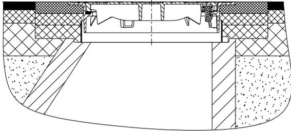
1.12 Schachtabdeckung mittels Rüttelwalze oder -platte mit einem Eigengewicht von min. 110 kg und einer Schlagkraft von min. 20 kN oberflächenbündig einrütteln bzw. einwalzen.
