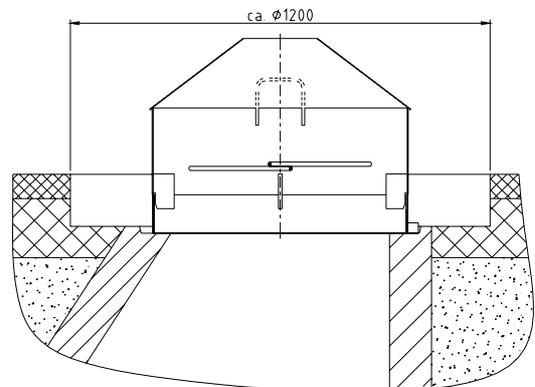
c) Vorhandene Aussparung außerhalb der Einbauschalung mit heißem Bitumenmischgut oberflächenbündig in Lagen von 40 – 80 mm verfüllen und gut verdichten.
