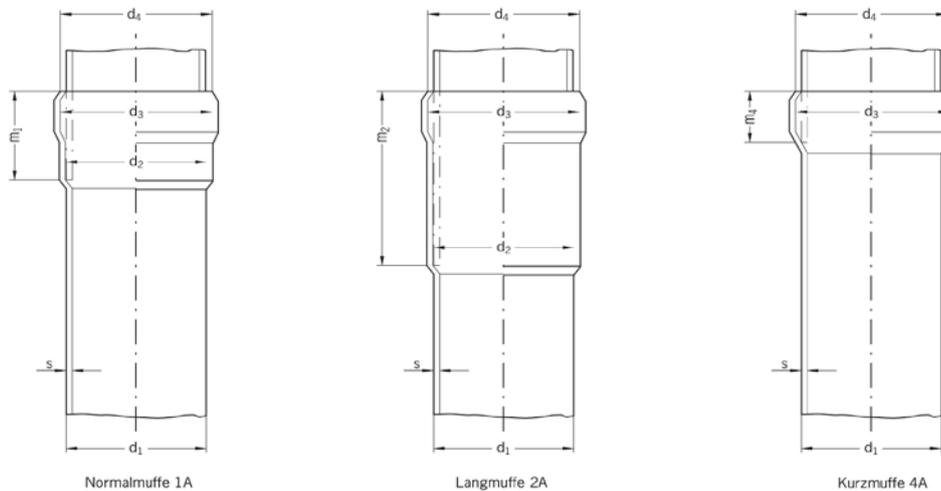
Bei Rohren und Formstücken mit 2 Muffen haben beide Muffen die gleiche Bauart.
