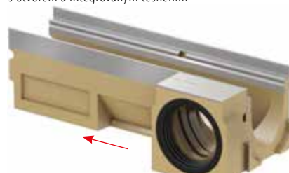
Boční odtok ve žlabu 0,5 m pomocí bočního předtvarování ve žlabu a čelní stěny s otvorem a integrovaným těsněním
